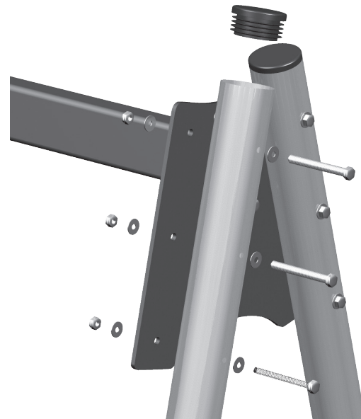
Kuva 4, teräsjalcojen kiinnitys. Yksi jalka: 3 kpl M12x120-ruuveja, 3 kpl M12 Nyloc -muttereita, aluslevyt molemmin puolin. Taaempi jalka valmiiksi kiinnitetty, suojatulppa (Ø 90 mm) paikallaan.
